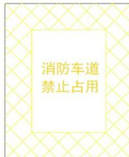
图 12 消防车通道出入口禁停标线及路面警示标志示意图
