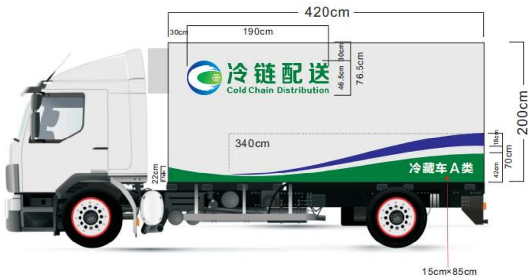
图 A.5 车辆左侧面标识位置示意图
