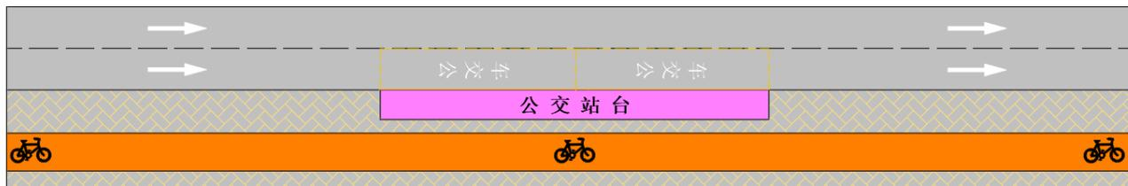
图 9 沿人行道设置的中途站（非机动车道后置）
